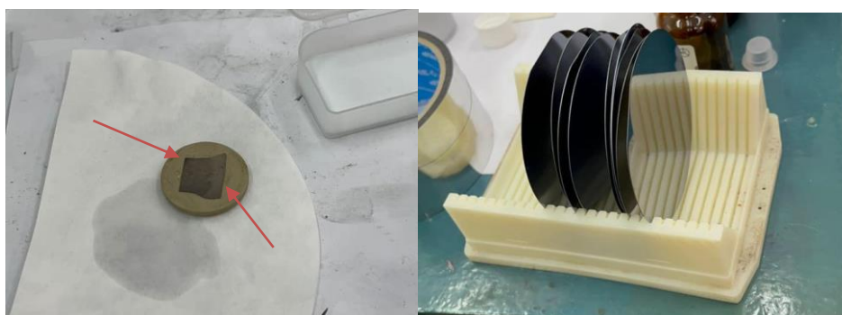
9 Сурет - HF қышқыл қоспалы электрохимиялық жолмен алынған кеуекті кремний
